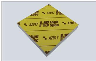
例えば板厚10ミリでは、板厚公差はJIS規格の約55%、平坦度は約40%の改善を実現しました。A2017(2000系のAl-Cu合金)は、ジュラルミンとも呼ばれます。耐食性、溶接性は劣りますが、強度が高く切削加工性も良い商品です。主に航空機用材、自動車用部材などに使用されます。
